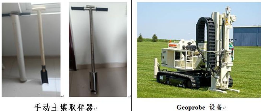
图 4-1 手动取样器和 Geoprobe 设备
